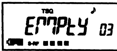
Anzeige leerer Kanalspeicher
